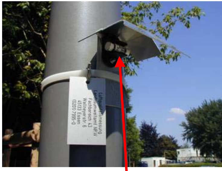
Abb. 2.2.1/2: Passivsammler vom Typ ORSA
