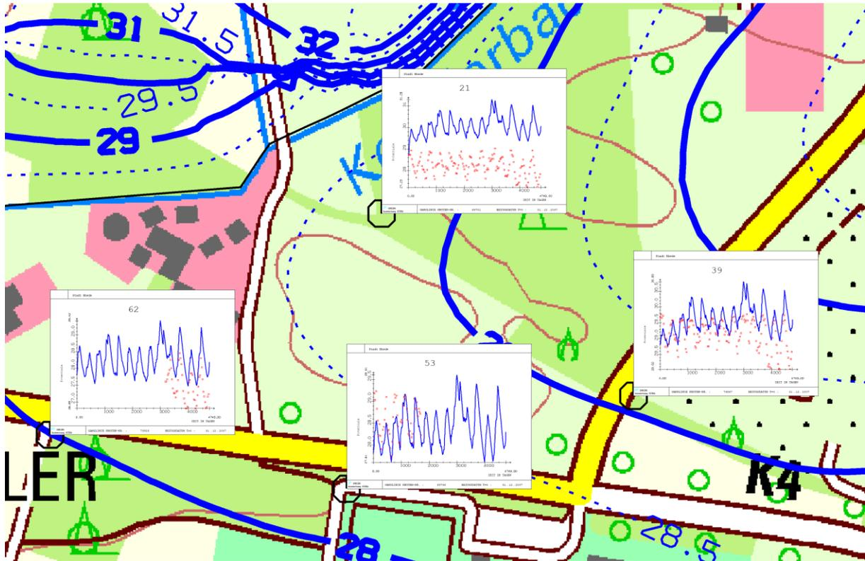
Abbildung 28: Vergleich gemessene (rot) und gerechnete (blau) Grundwasserstände am Oberlauf des Kettelerbaches
